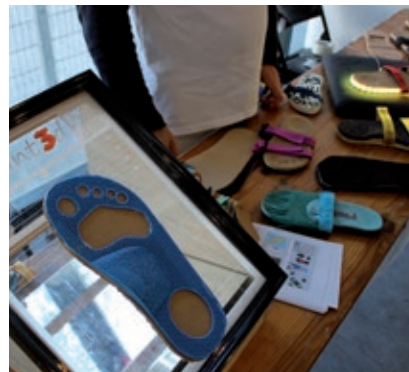
Tongs en liège imprimées en 3D par Form'maker .
